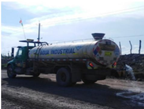
Fotografía 12. Uso de agua para el riego de las vías circundantes a la mina, con el objetivo de bajar el nivel de polvillo en el aire. Tomada por Liza Gaitán (2019).
